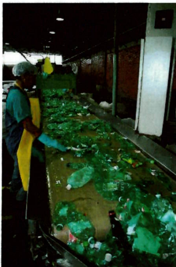
Figura 20: Linha de seleção de PET para reciclagem
